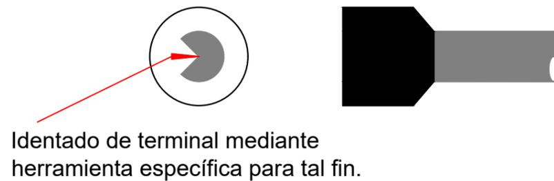
Identado de terminal mediante herramienta específica para tal fin.
